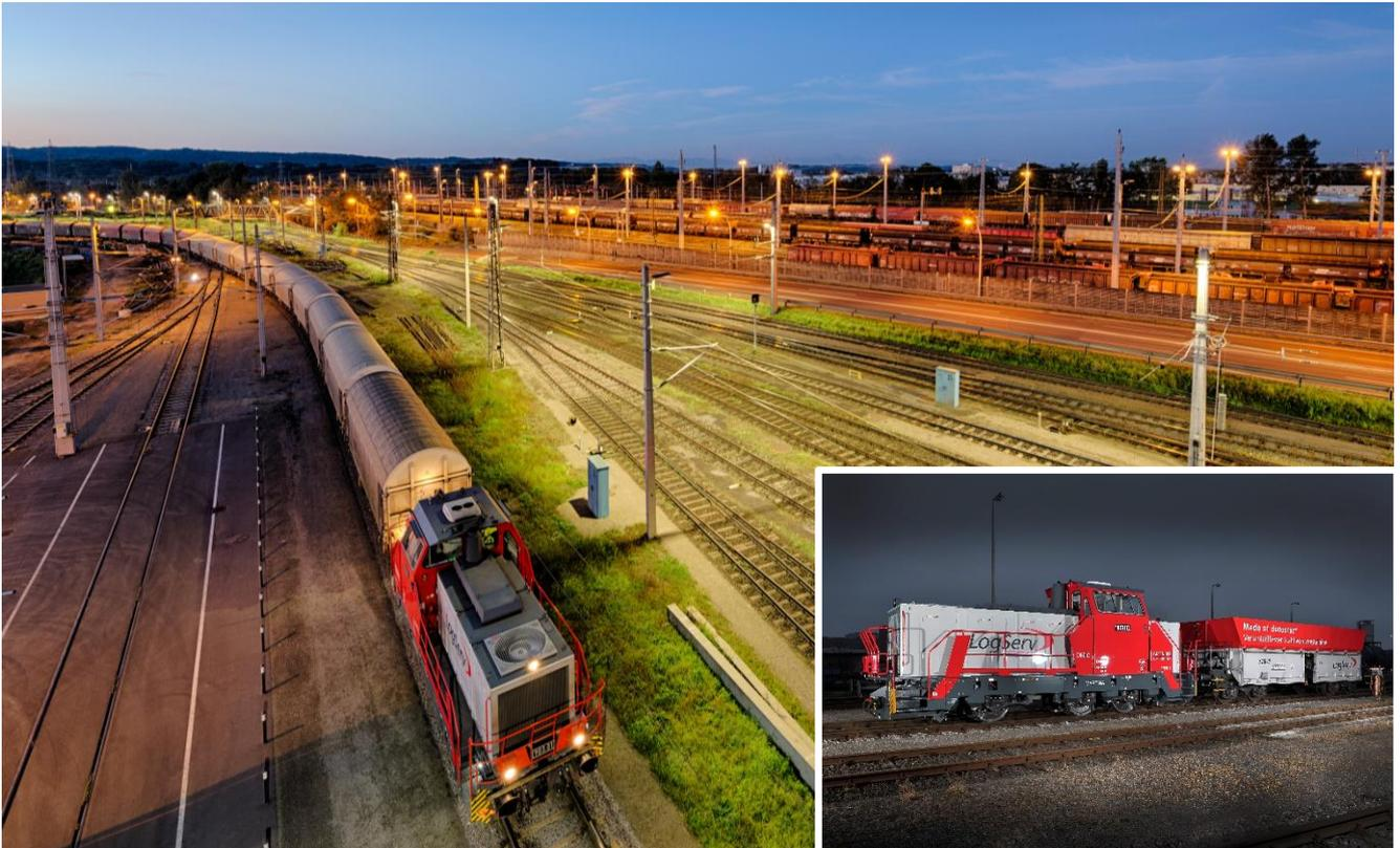
Bei der D60 C handelt es sich um eine kompakte 3-achsige Lokomotive mit diesel-hydraulischem Antrieb. In den letzten Jahren wurde diese Lokomotive immer weiterentwickelt und entspricht heute dem neuesten Stand der Technik.
